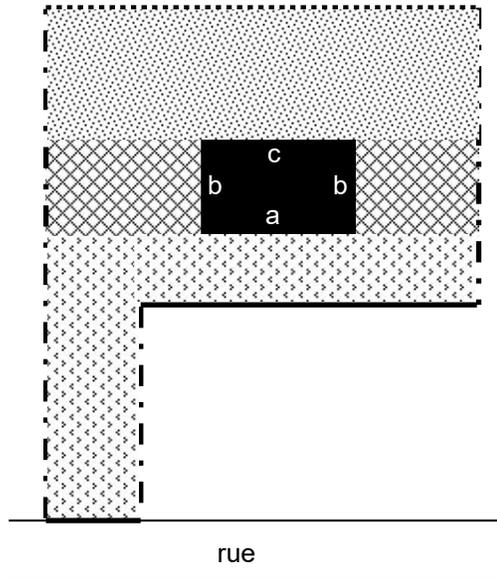
Note : Pour un terrain partiellement enclavé, une ligne de terrain positionnée à un angle inférieur à 45° par rapport au mur avant du bâtiment principal est aussi considérée comme une ligne avant (à l'exception des lignes arrières)
