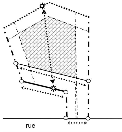
Note : Pour tout type de terrain, les lignes brisées ou segmentées non perpendiculaires s'ajoutent aux fins du calcul des mesures.
