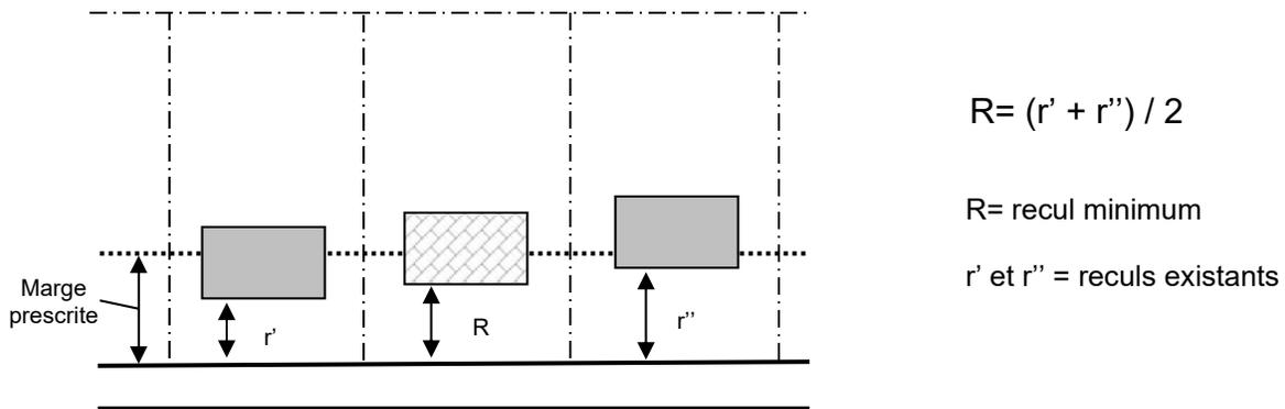
Lorsqu'un bâtiment doit être implanté sur un terrain vacant situé à la suite du dernier bâtiment existant sur une rue, la marge de recul avant doit être celle prescrite par la réglementation de la zone si le bâtiment existant n'empiète pas de plus de 1,5 mètre dans la marge prescrite ou si le bâtiment projeté est éloigné à plus de 30 mètres du bâtiment existant.
