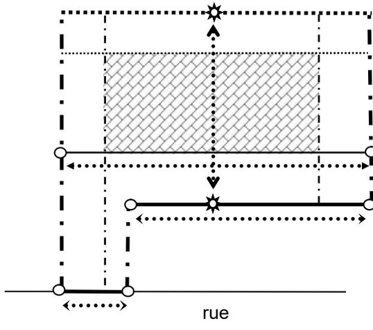
Note : Pour un terrain partiellement enclavé, une ligne de terrain positionnée à un angle inférieur à 45° par rapport au mur avant du bâtiment principal est aussi considérée comme une ligne avant (à l'exception des lignes arrières)
